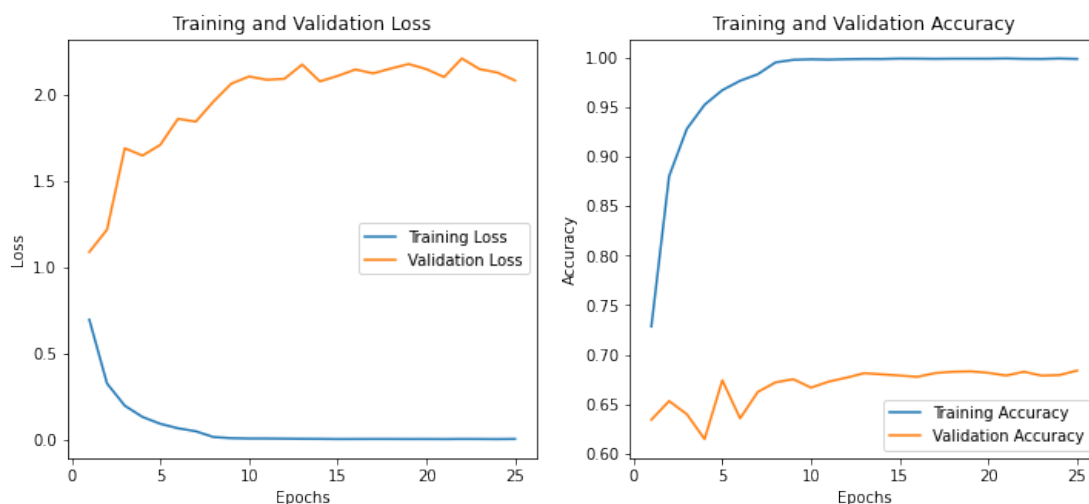
Figur 4.1.1: Læringskurver for forsøk 1. Graf til venstre viser Training og Validation Loss over epochs. Graf til høyre viser Training og Validation Accuracy over epochs.
