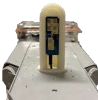
Figur 3-6: Overbygg med radar sett forfra
