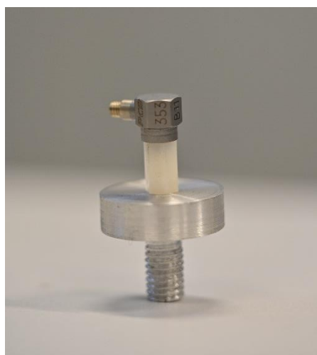
Figur 3.17 - Sensorfeste med plast-skrue uten kabel, til fallmaskinen
