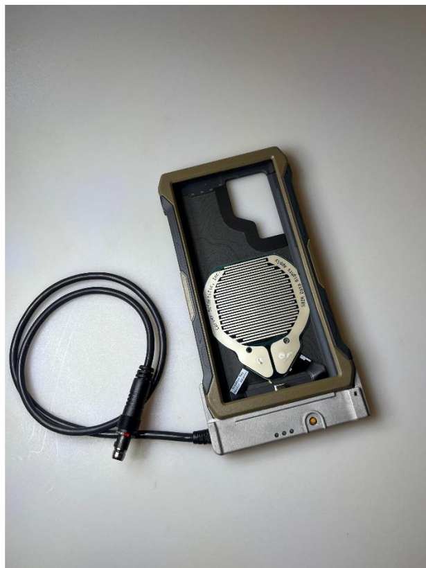
Figur 7: Eksempel på deksel til COTS enhet med varmemefolie integrert. Bilde innhentet fra FMA med godkjenning om bruk i oppgaven.
