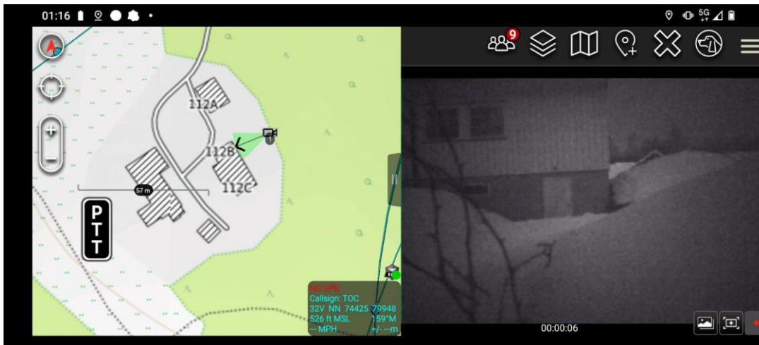
Figur 5: ATAK programvaren under testing viser direktevideo med retning brukeren filmer i kartet.
