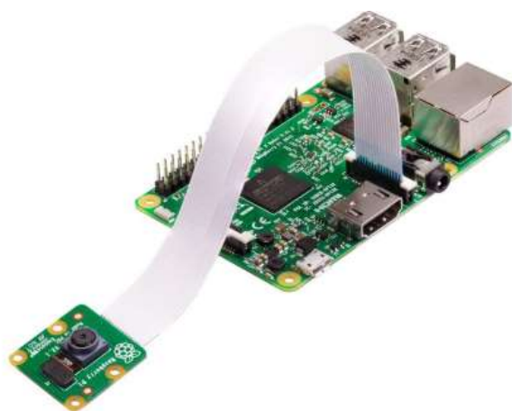
Figur 3-3: RPi Camera tilkoblet en RPi. Hentet fra (Elfa Distrelec, 2022)
