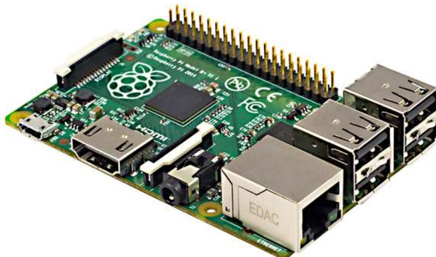
Figur 3-5: Raspberry Pi 3B+. Hentet fra (Elfa Distrelec, 2022)
