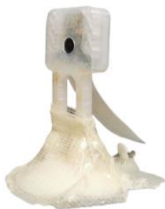
Figur 3-4: Kamerahuset til kameraet.
