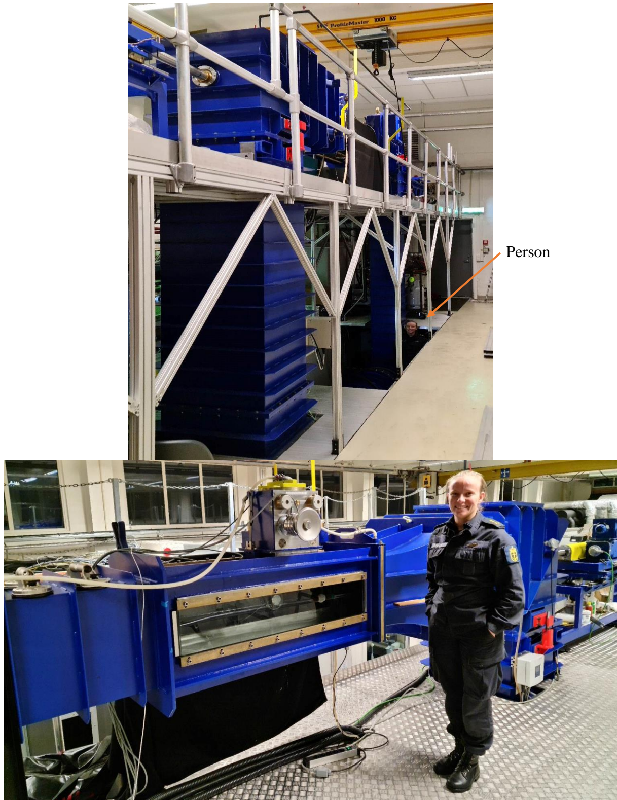
Figur 13: Bilde av en person ved kavitasjonstunellen og dens måleseksjonen. Bare måleseksjonen er 650 mm bred x 350 mm høy. Tunellen i seg selv strekker seg over tre etasjer. Personen er 1,63 m.
