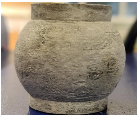
Figur 15: Bilde av hylsen som monteres istedenfor propellen.
