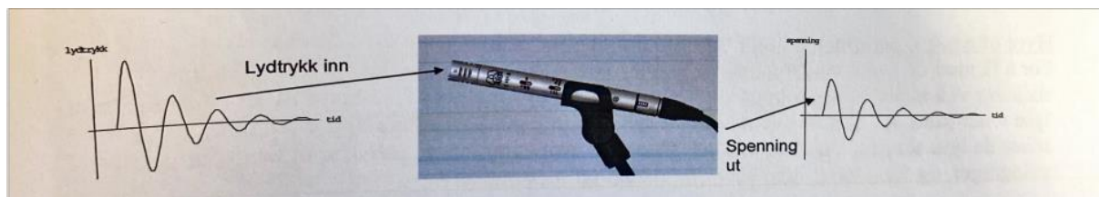
Figur 3: Omgjøring av lydtrykk til spenning. Grafen er en konsekvens av inngangssignalet (Tveita, 2012, s. 67).
