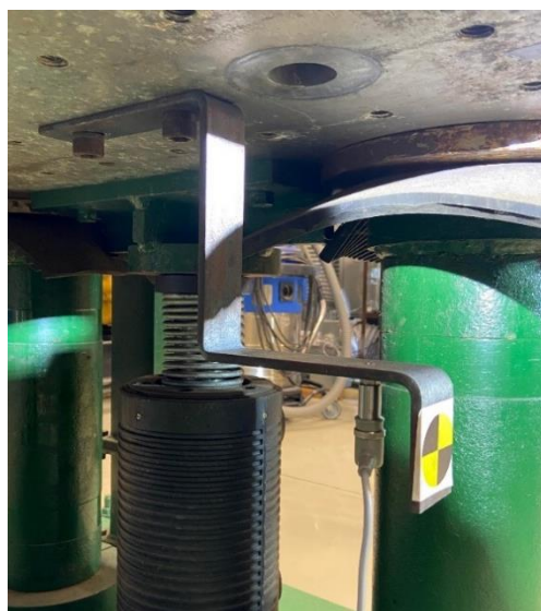
Figur 3.3 - Flattjernfeste for akselerometer og template tracker
