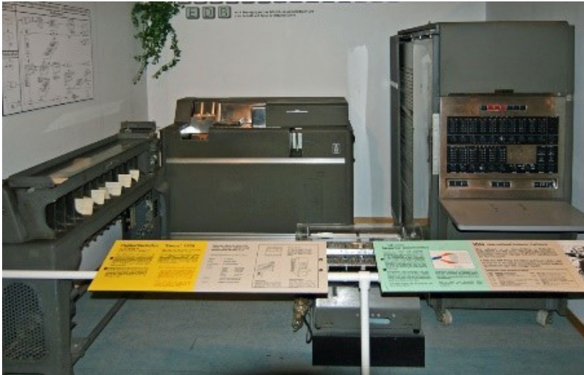
EMMA står i dag på Norsk Teknisk Museum. Sentralenheten til høyre, inn-ut-enheten i midten og hullkortsorterer til venstre. Bildet er fra Wikipedia.
