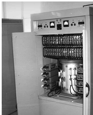
Detalj av innmaten til den elektroniske regnemaskinen FREDERIC. I midten av skapet ses den magnetiske trommel-hukommelsen. Fotografert på Kjeller, 25. mars 1966
