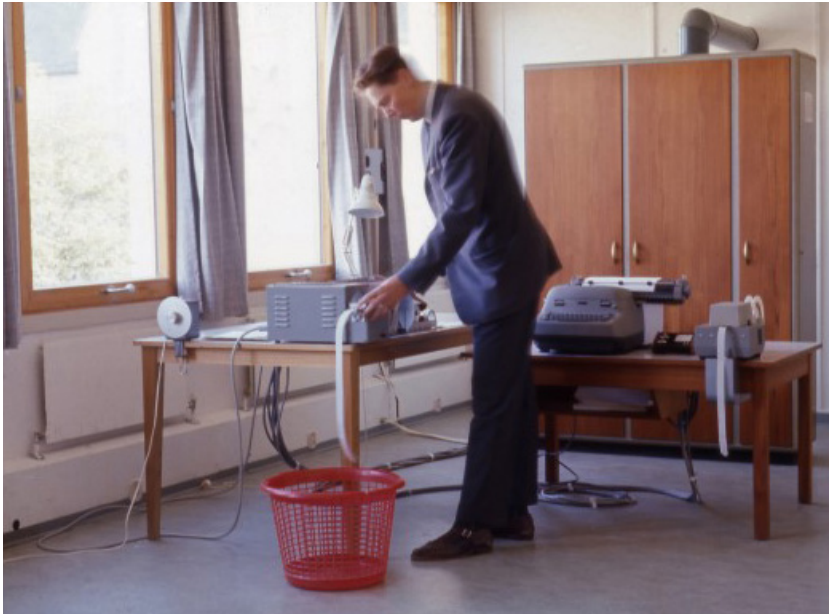
Den første norske GIER-maskinen ankom Regnesenteret NTH i november 1962. På bordene ses fra venstre til høyre: spolemaskin for hullbånd, hullbåndleser (det ferdig leste båndet havner i søplebøtta før det blir spolt opp igjen), en samling hullbånd i en programkasse, en online-terminal (skrivemaskinen), start-/stopknappen og en hullbåndpunch. Selve maskinen er skapet ved veggen. Personen på bildet er Olav B. Brusdal. GIER og Olav B. Brusdal ved Regnesenteret NTH, ca. 1963. Av Ukjent/SINTEF Kommunikasjon. Lisens: Begrenset gjenbruk.
