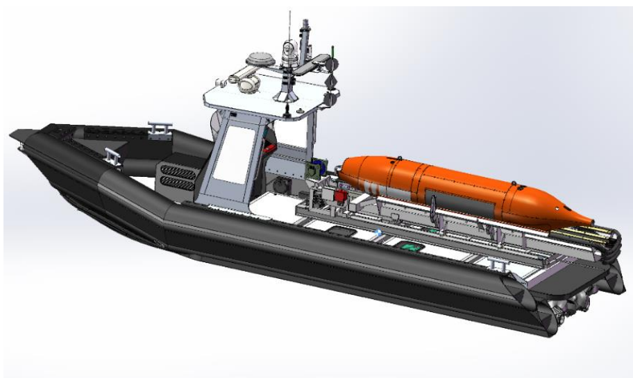
Figur 24: FFI sitt forslag til autonomt Launch and Recovery (L&R) system om bord på deres ODIN fartøy. (Vedlegg 4)
