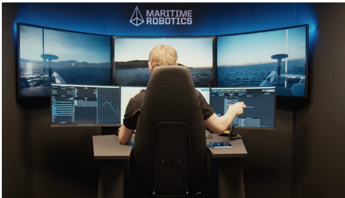
Bilde 2: Operatørstasjonen til Maritime Robotics (Eirik Hovstein) Merk: her er låringen ikke presentert.
