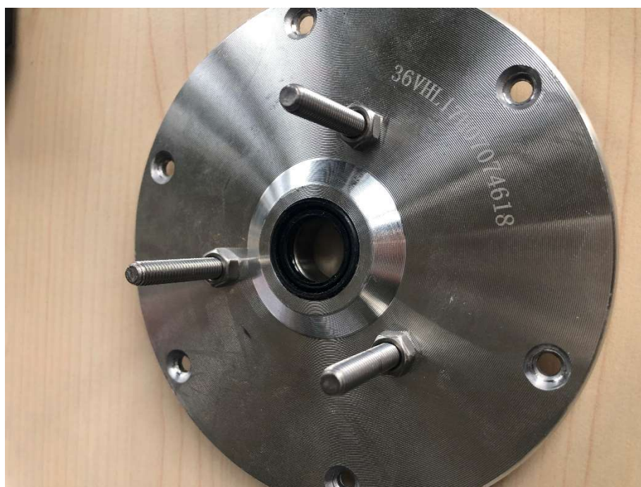
Figur 2.20: Deksel til motor med feste til bremseskive
