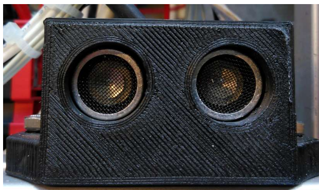
Figur 2.19: Ultralydsensor plassert inne i 3D-printet brakett, montert på ramme.
