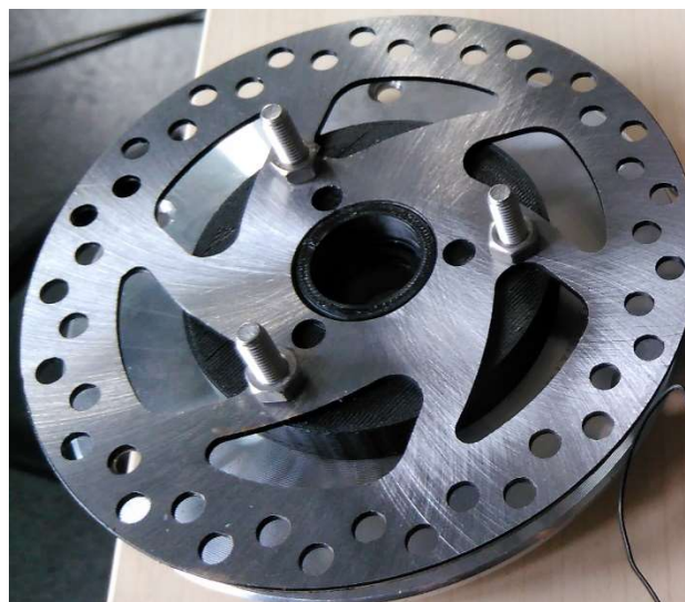
Figur 2.22: Bremseskive brakett i sort plast, sentrerer bremseskiven på motorlokket.
