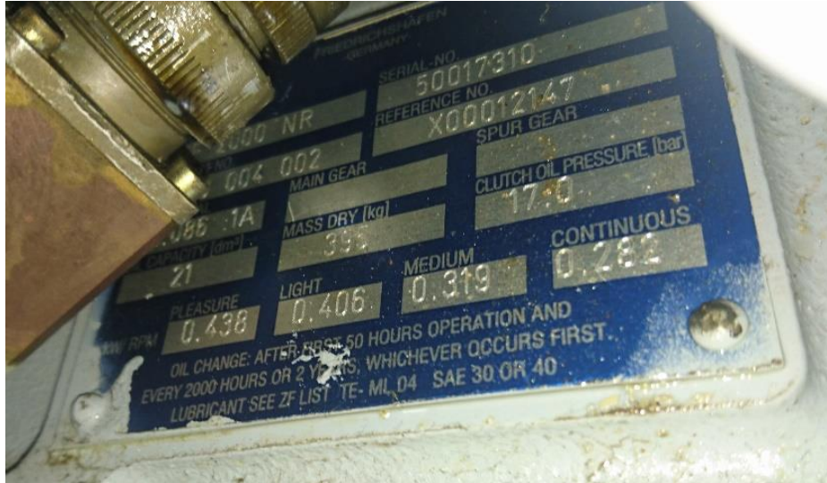
Figur 5. Bilde av merkeskilt til giret på løfteviftmotor
