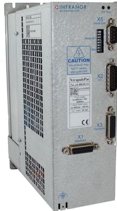
Figur 17 XtrapulsPac fra Installasjonsguide
