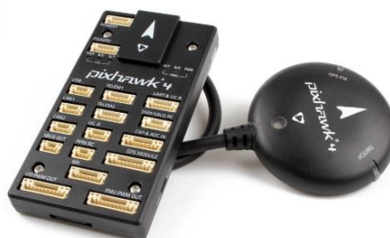
Figur 4-3: PX4 med GPS modul (getfpv, 2019)
