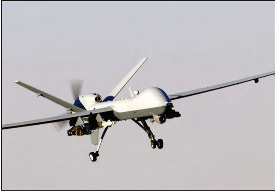
Bilde 2.9: MQ-9 Reaper kan holde seg over 30 timer i lufta, og kan bære flere typer presisjonsvåpen. (Foto: Staff Sgt. Brian Ferguson / U.S. Air Force)
