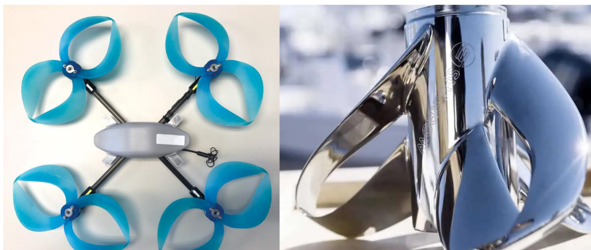
Figur 2: MIT luft toroidpropell og Sharrow marine toroidpropell
