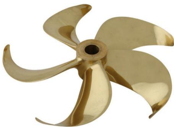
Figur 3: 1:28 skalert modell av en Kappel Alpha 6.4 m diameter propell (The Motorship 2012b).
