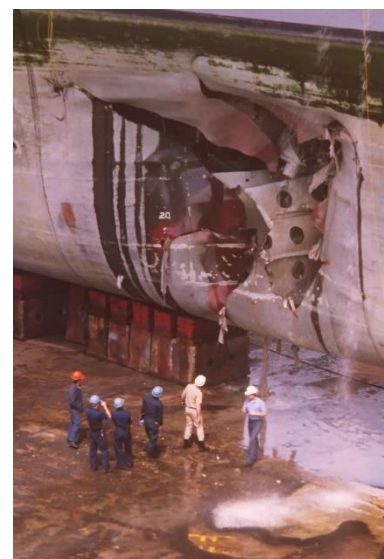
Figur 8 Skader på USS Tripoli etter mineeksplosjon (Kilde: Truver, 2016)
