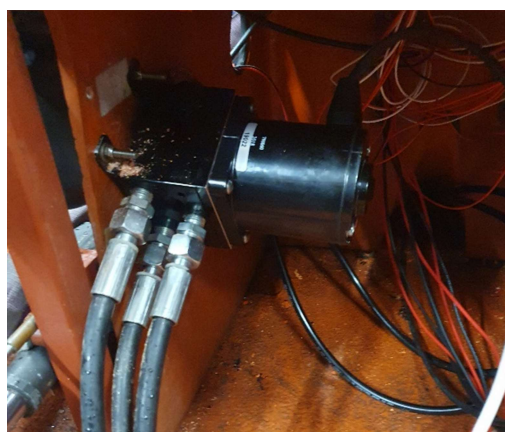
Figur 3.6: Pumpen som benyttes til fjernstyring. Pumpen er montert under styringskonsoll, og skjermet for det verste av vær og sjø. De tre slangene som går ut fra pumpen er hydraulikkslanger som kobler pumpen sammen med originale rattpumpen. Slangene går til styrbord og babord retning, den siste går til tank. Bilde t.v. (Marineshop AS, 2022)
