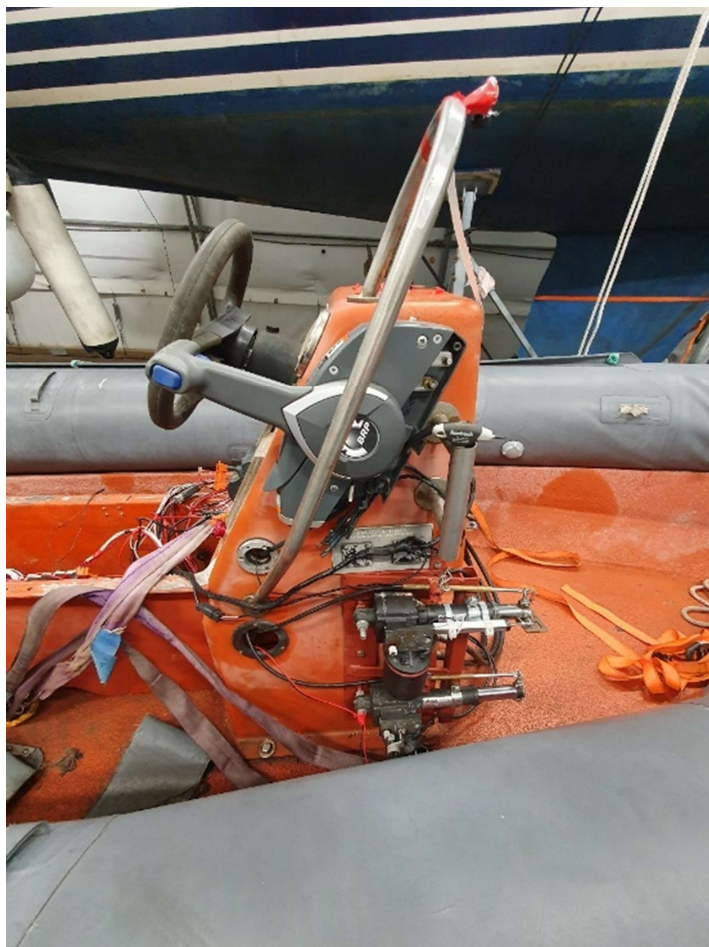
Figur 3.4: Brakett med sylindre og påsatt wire montert under original spak.
