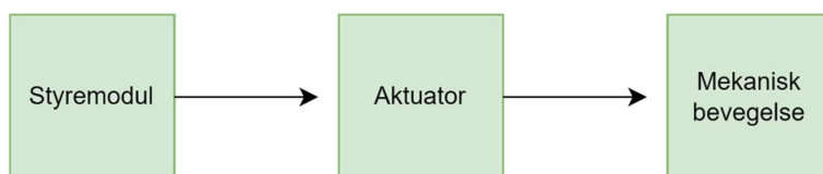
Figur 2.5: Gangen i styring, fra styremodul til mekanisk bevegelse
