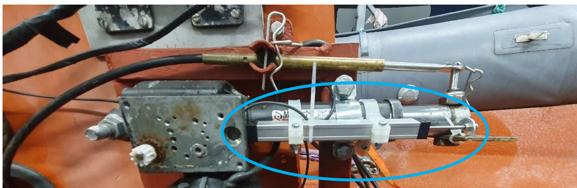
Figur 3.18: Påmontert lineært potensiometer for å styre gir. Festeordning er 3D-printet av Frode Wikne ved SKSK.
