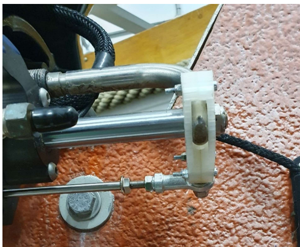
Figur 3.16: Brakett for å feste potensiometeret til motor-staget.
