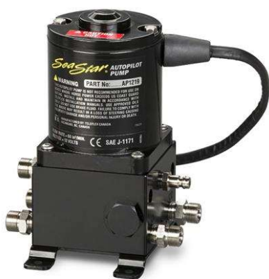
Figur 3.6: Pumpen som benyttes til fjernstyring. Pumpen er montert under styringskonsoll, og skjermet for det verste av vær og sjø. De tre slangene som går ut fra pumpen er hydraulikkslanger som kobler pumpen sammen med originale rattpumpen. Slangene går til styrbord og babord retning, den siste går til tank. Bilde t.v. (Marineshop AS, 2022)
