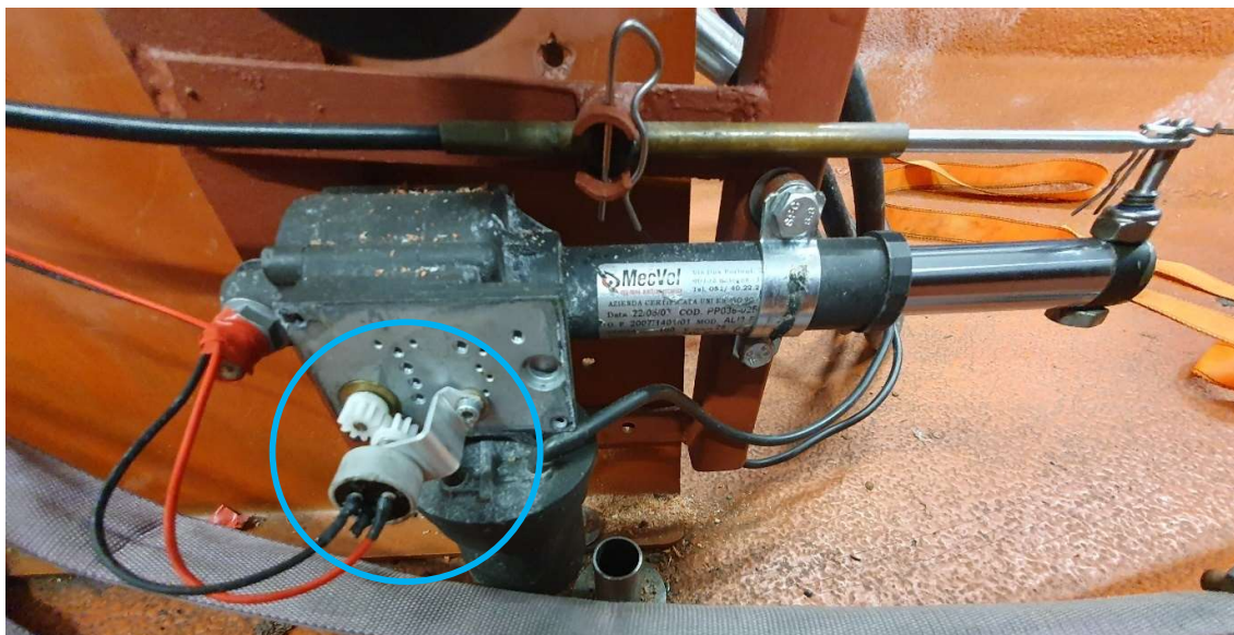
Figur 3.17: Potensiometer på pådrags-aktuator, med to tannhjul.
