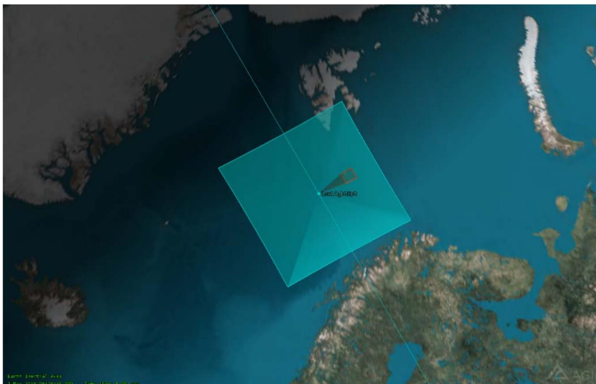
Figur 12. Det praktiske deteksjonsområdet til en optisk sensor (Kilde: Eriksen, 2020).
