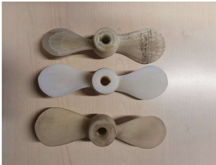
Figur 3.12 Bildet viser propeller som ble 3d-printet. Den øverste propellen er i fiberforsterket nylon, den midterste propellen er i HIPS, og den nederste er fiberforsterket nylon som er belagt med epoxy.
