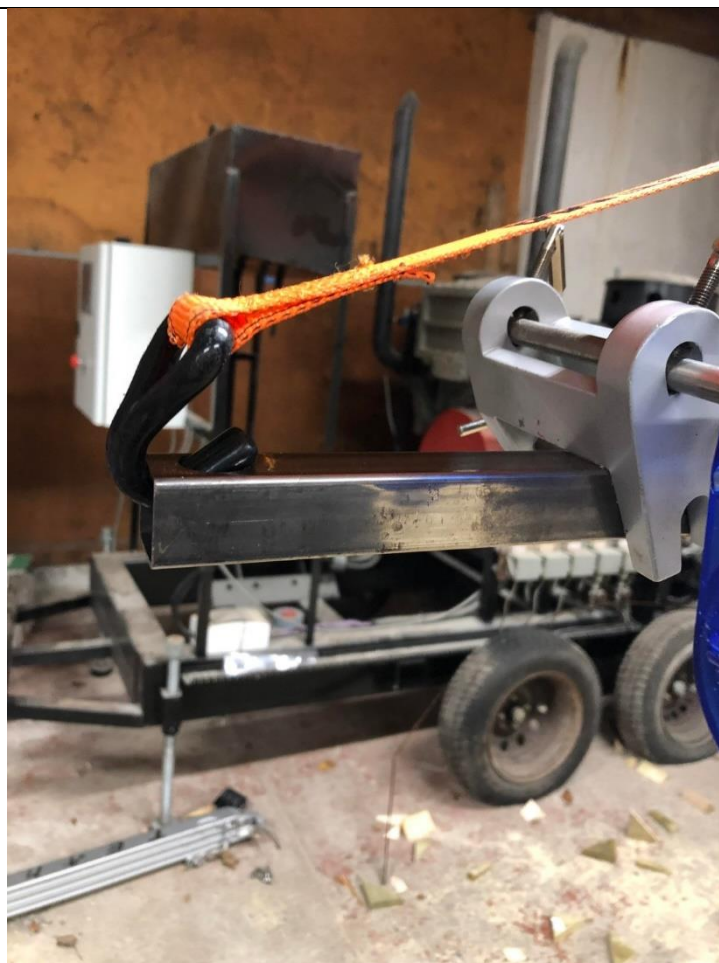
Figur 21: Innfestning av jekkestropp for å holde riggen horisontal
