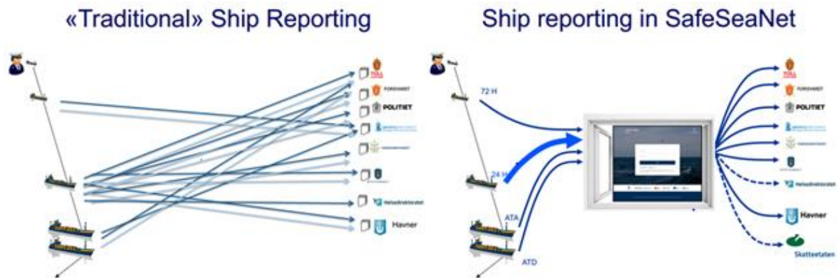
Figur 8: Viser til venstre tradisjonell skips rapportering. Figur til høyre viser skipsrapportering ved bruk av SafeSeaNet
