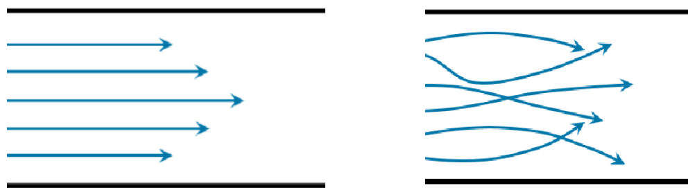
Figur 2.14 Laminær strømning (venstre) og turbulent strømning (høyre) (SimScale, 2020)
