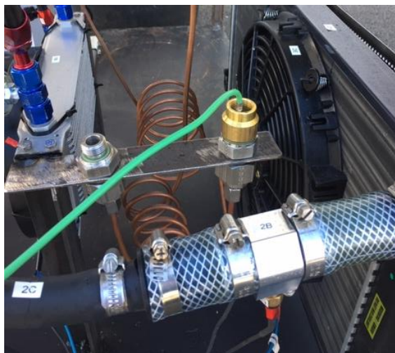
Figur 4.5 Temperaturmåling av luften i T03
