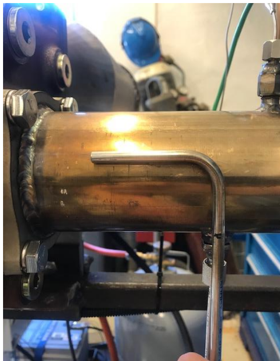
Figur 3.18 Illustrasjon av hvordan pitotrøret er plassert i T04
