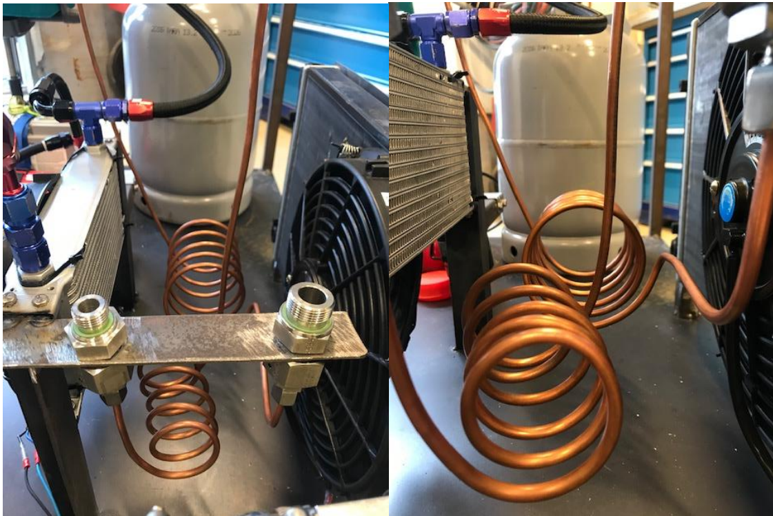
Figur 3.21 Kjøling til trykksensorene
