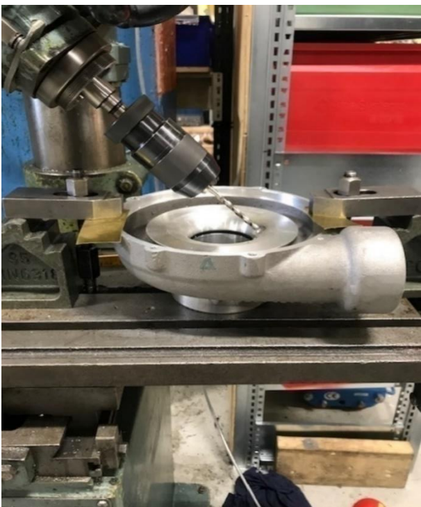
Figur 3.28 Oppspenning i søyleboremaskin
