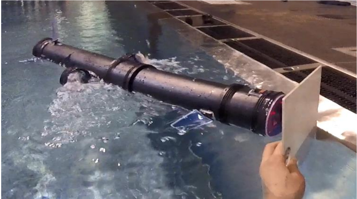
Figur 175: Failsafen setter dronen i revers og hindrer kollisjon, merk bakerste finne
