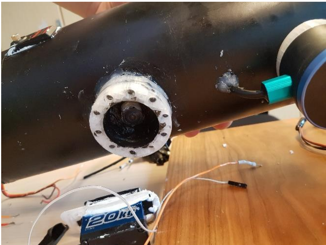
Figur 24: Montert kamera av typen wide-angle Pi-kamera med lysdioder rundt. Merk sonaren til høyre
