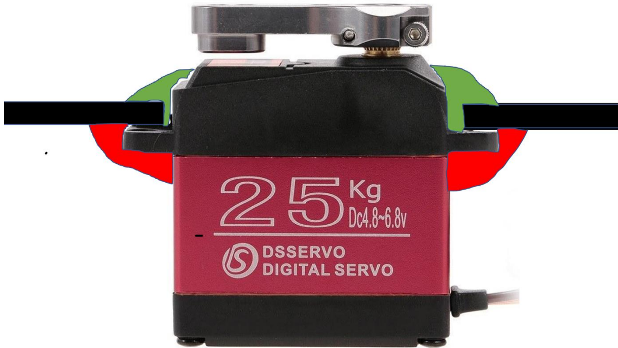
Figur 35: skisse av tetningen rundt servomotorene. Skroget er tegnet i sort, rød er lim av typen Tec-7 og det grønne er silikon.
