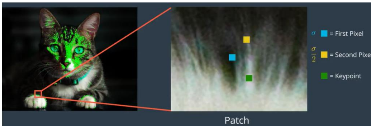
Figur 123: Utsnitt av et bilde der man fokuserer på et nøkkelpunkt. Bildet til høyre viser det definerte området rundt nøkkelpunktet(patch). Kilde: https://medium.com/@deepanshut041/introduction-to-orb-oriented-fast-and-rotated-brief-4220e8ec40cf
