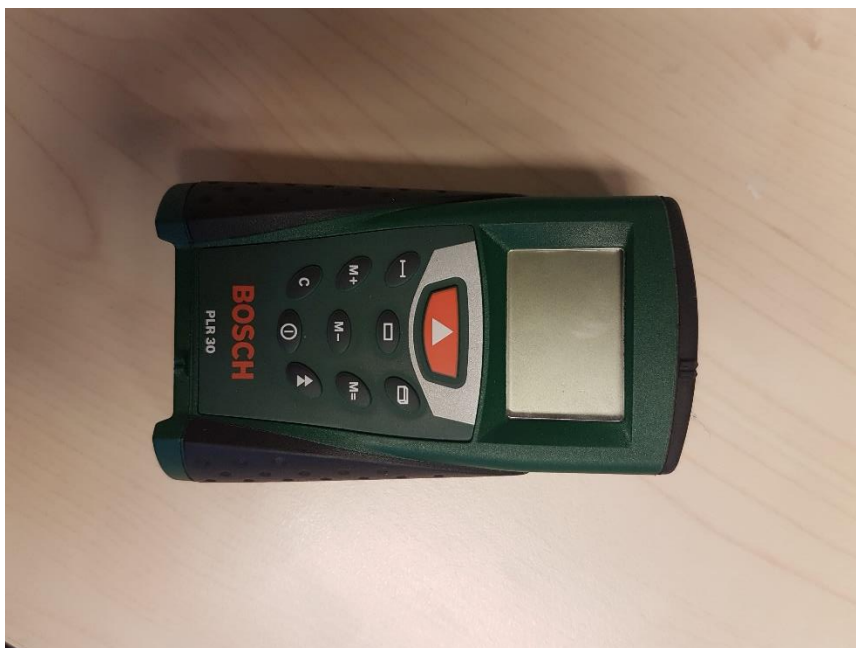
Figur 154: Laser avstandsmåler brukt til å måle faktisk avstand
