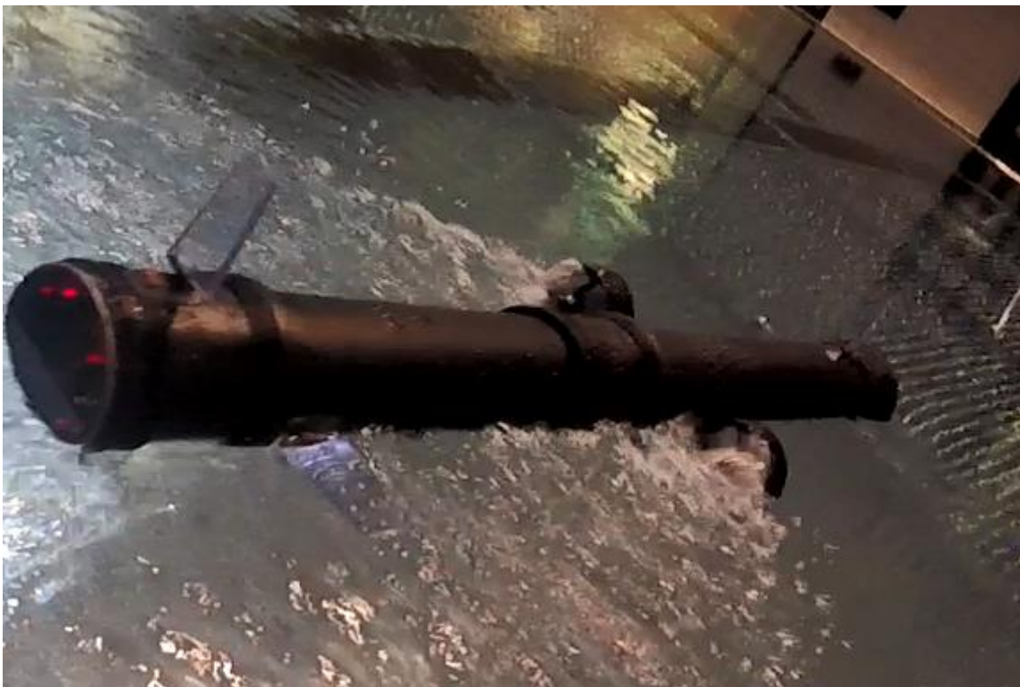
Figur 173: Det er tydelig ut fra bildet at dronen beveger seg bakover ved å se på strømmingen fra motorene
