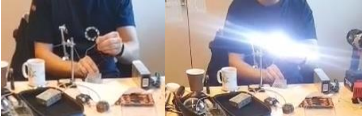
Figur 25: test av lysstyrken til lysdiodene, dette er godt nok lys til å teste kameraet nært bunnen
