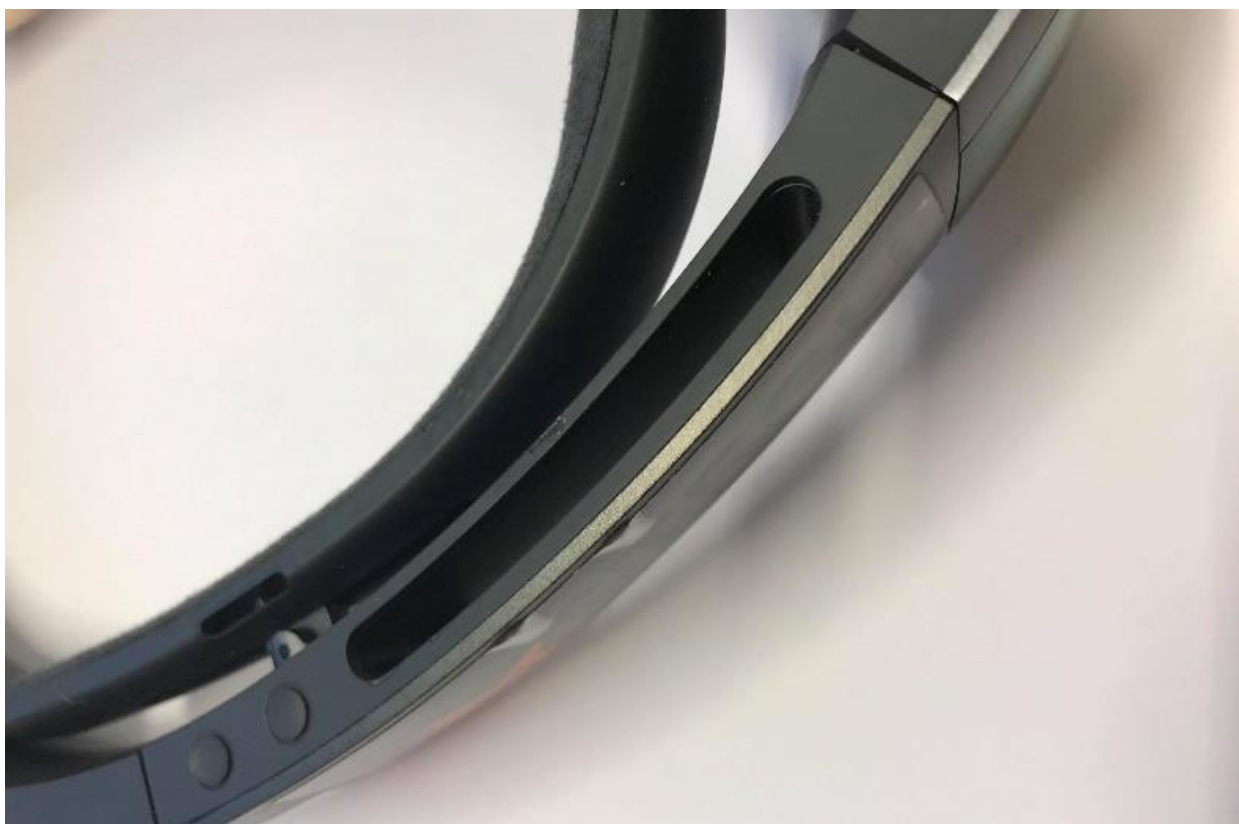
Figur 68 Viser ventilasjonskanalen som bøylen blir plassert i.
