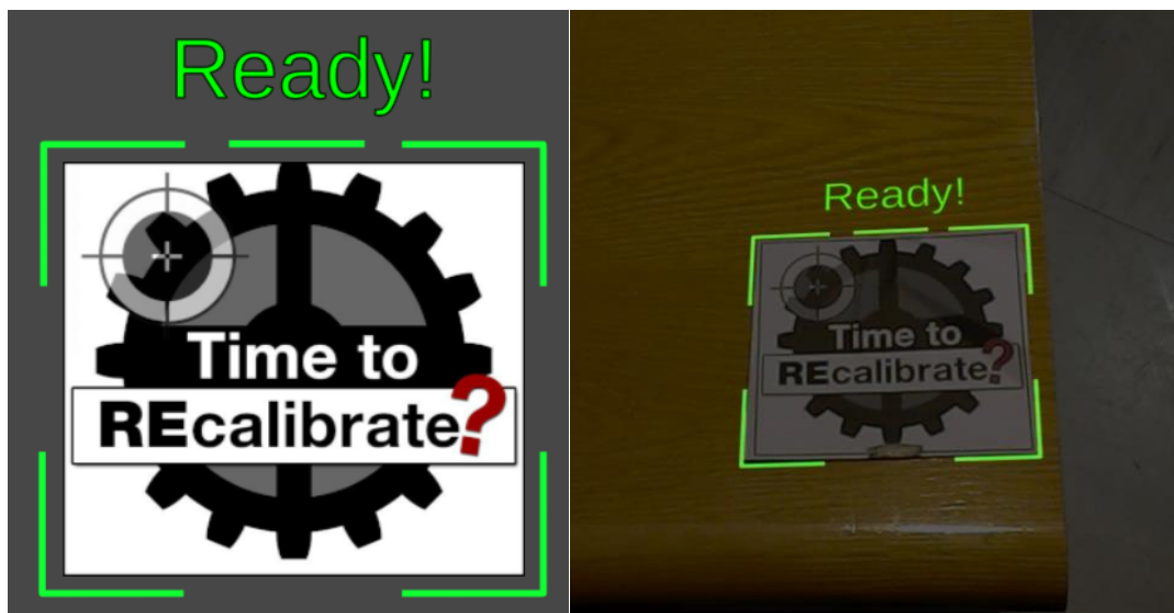
Figur 63 Venstre: bildemålet i Unity. Høyre: bildemål gjenkjent av Vuforia.
