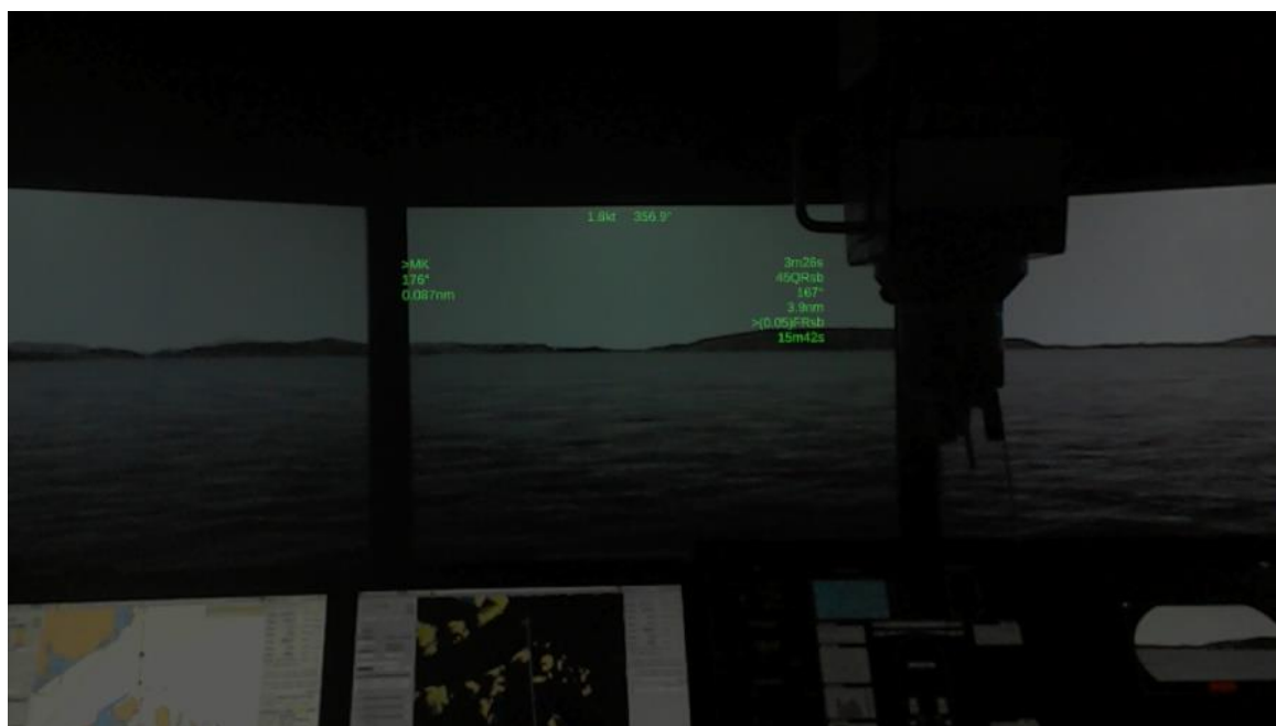
Figur 73 Augmented reality løfter informasjon opp fra panelene..
