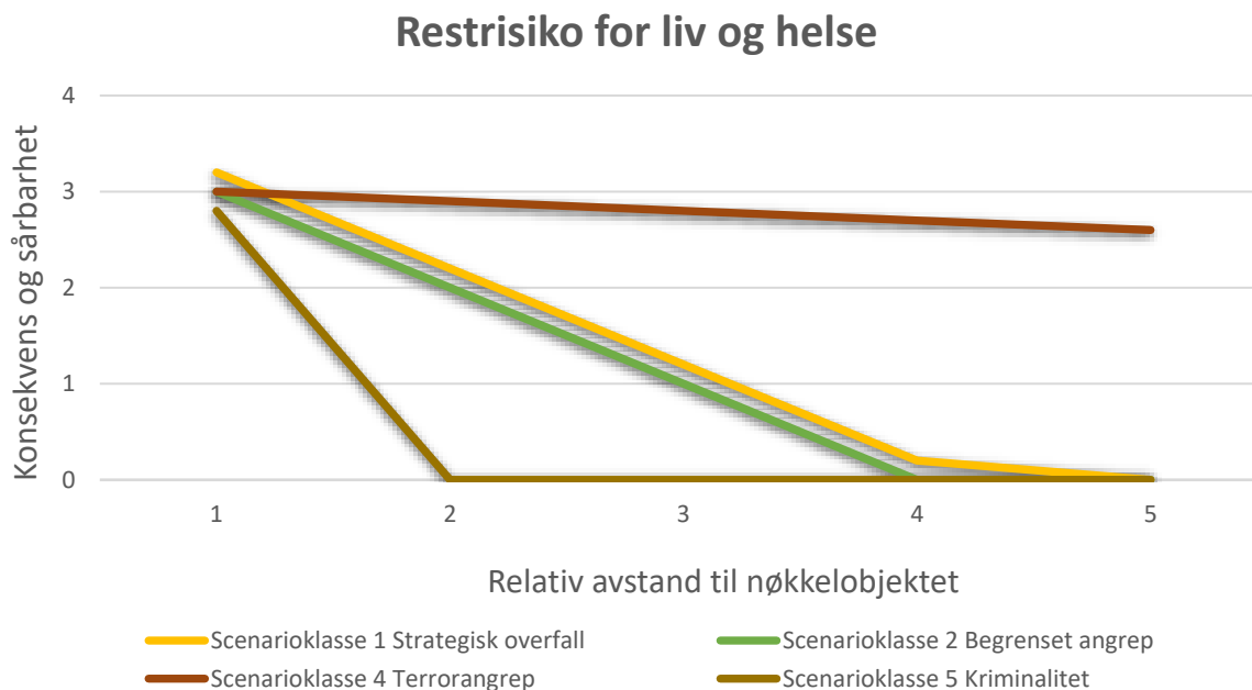
Figur 26 Prinsippdiagram over restrisikoen opp mot avstanden mellom dekningsrommet og nøkkelobjektet
