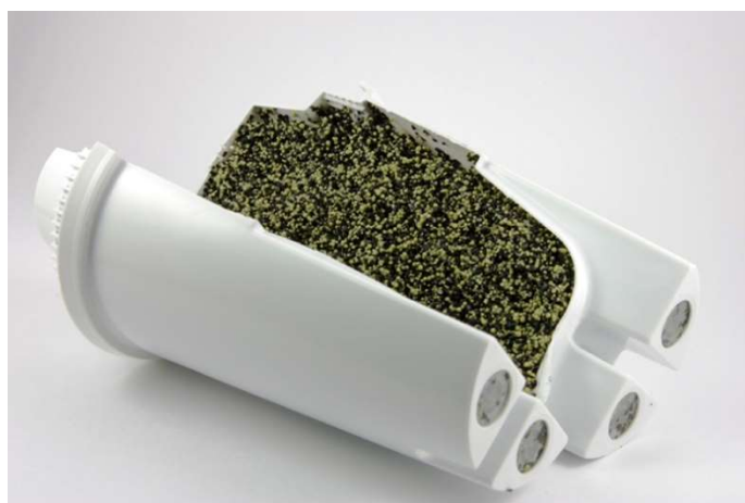
Figur 1: Snitt av adsorpsjonsfilter med aktivert karbon (Conley, 2019).
