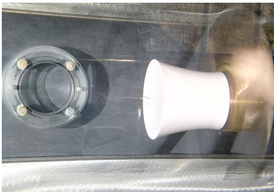
Figur 42 Kavitasjon i sone 2 – Modell 4
