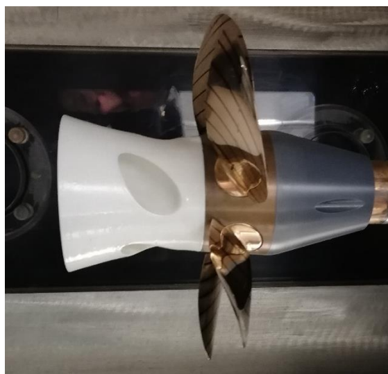
Figur 46 Modell 5 montert i kavitasjonstunellen
