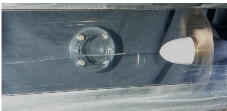
Figur 23 Kavitasjon i Sone 1 – Modell 1
