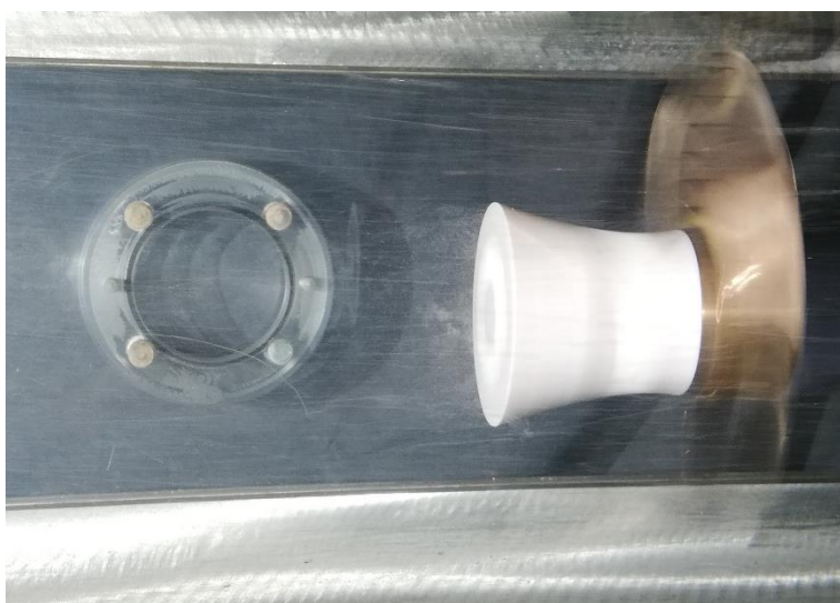
Figur 50 Kavitasjon i Sone 2 – Modell 5
