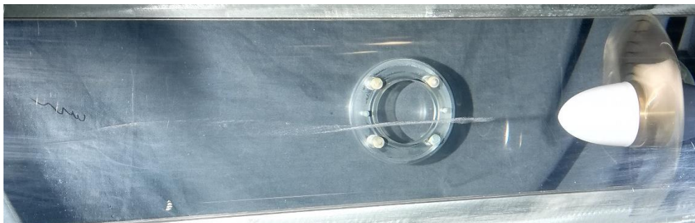
Figur 24 Kavitasjon i Sone 2 – Modell 1
