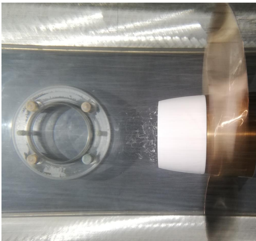
Figur 29 Kavitasjon i Sone 2 - Modell 2
