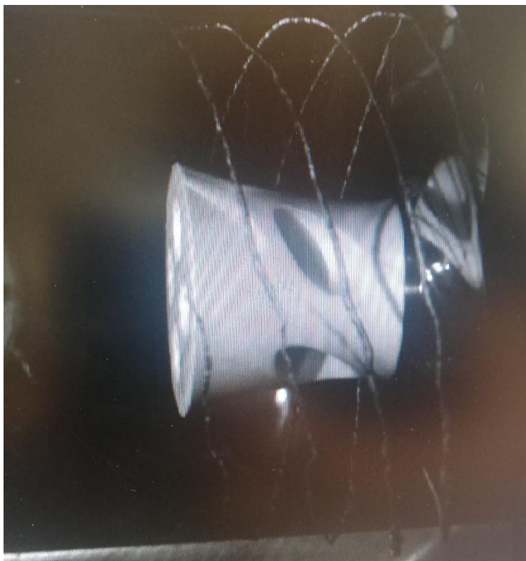
Figur 49 Kavitasjon i Sone 1 – Modell 5
