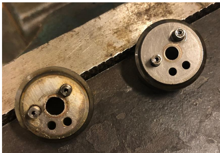
Figur 2-1: Slitt mellomleggsring til venstre, sammenlignet med lite brukt til høyre.
