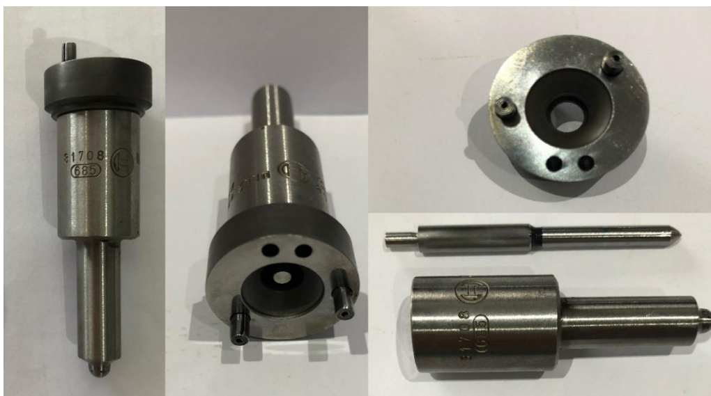
Figur 4-4: Ubrukt mellomleggsring, dyse og dysenål tilhørende MTU 396 fra Nansen klasse fregatt.
