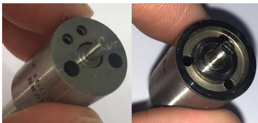
Figur 4-7: Dyse fra Fregatt t.v, fra Mine med "vollgrav" t.h.
