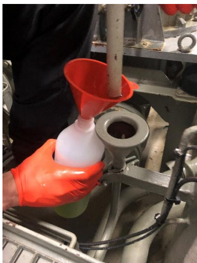
Figur 4-1: Bilde fra prøvetaking av brennstoff ved KNM Thor Heyerdahl, 25.04.2019.
