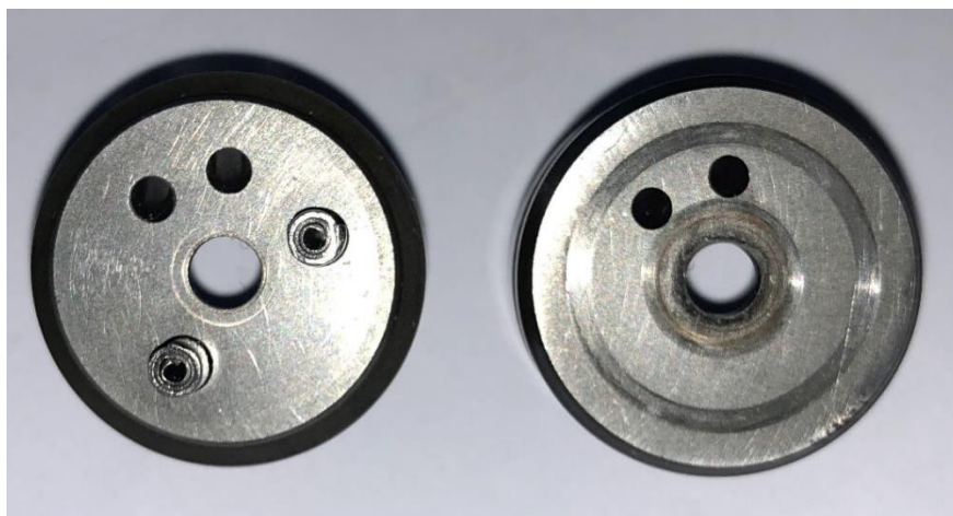
Figur 4-6: Mellomleggsring Fregatt t.v, minefartøy t.h. Her ser man tydelig forskjell ved at fregatten har styrepinner.
