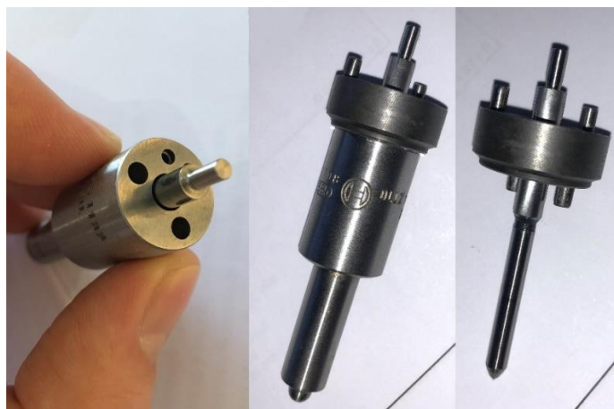
Figur 4-10: Illustrert dysenål gjennom senterhull på mellomleggsring Fregatt.
