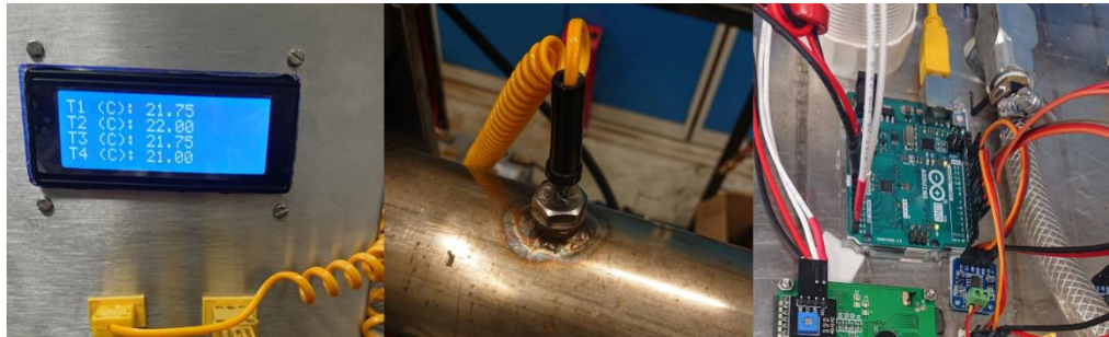
Figur 3.39 Til venstre: Arduino-plattformen omsetter signalene fra temperaturgiverne og viser de som tallverdier på LCD-skjermen. I midten: Temperatursensor nedfelt i eksospotten. Til høyre: Arduino-plattformen (i midten av bildet)
