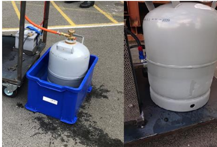
Figur 3.12: Til venstre: Propantank plassert i vannbad. Til høyre: Frostdannelse på utsiden av tanken ved kjøring uten vannbad
