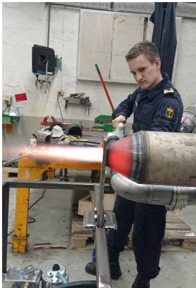
Figur 3.16: Kadett Panfilovs under test av brennstoffsystemet
