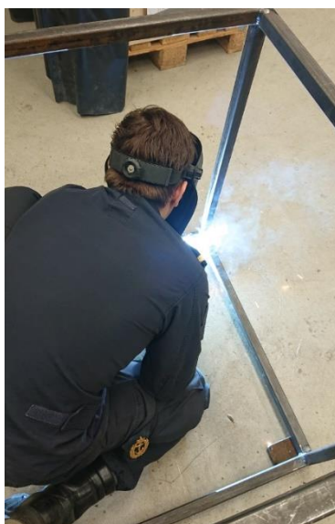
Figur 3.4: Kadett Panfilovs under sveising av rammen
