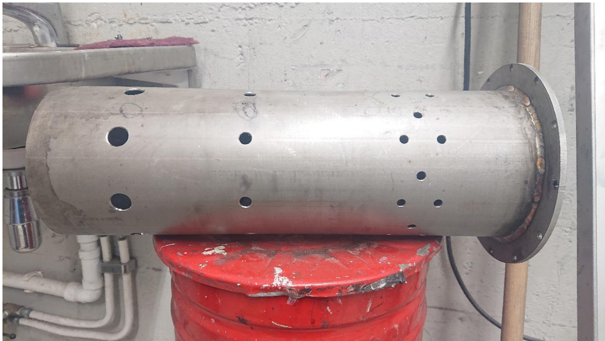
Figur 3.7: Flammerøret etter produksjon
