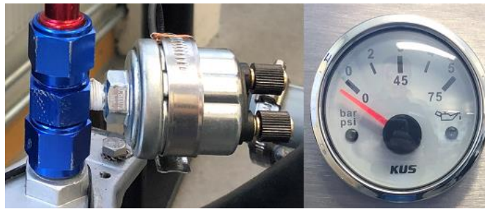
Figur 3.28: Oljetrykksensor og viser for oljetrykk
