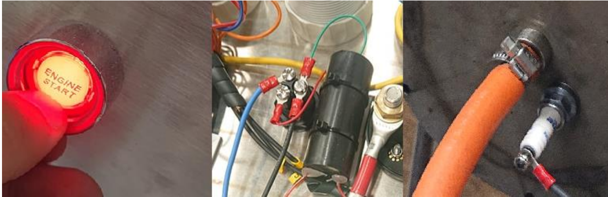
Figur 3.35: Tenningsystemet. Fra venstre: Tenningsbryter med LED-lys ved aktivering, coil (svart sylinder) og baksiden av bryter, tennplugg og gassinnføring
