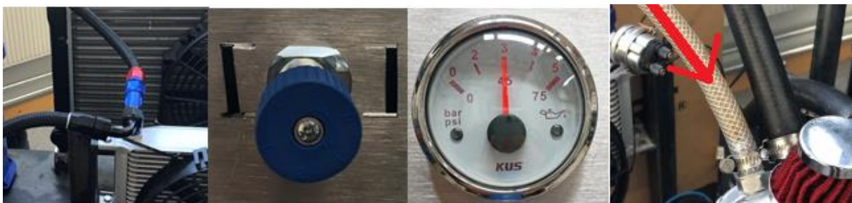
Figur 3.22: Fra venstre: Treveis-kobling, strupeventil, oljetrykksviser, bypass-slange ned i tanken
