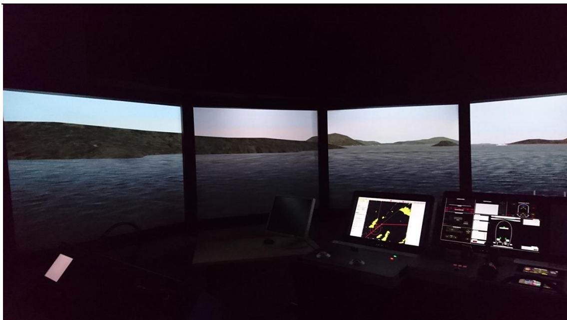
Figur 5. Bilde av skjermene i simulatoren når en passerer land om babord med passeringsavstand i henhold til planen
