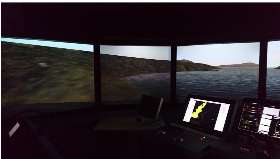
Figur 4. Bilde av skjermene i simulatoren når en passerer land om babord uten å ha tatt fartøyet ut av banestyring
