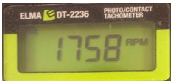
Figur 79 - Måling av RPM ved 30Hz (Tachometer)
