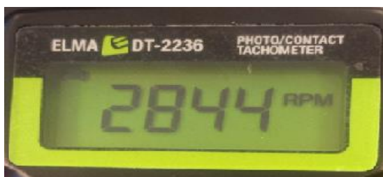
Figur 74 - Måling av RPM ved 50Hz (Tachometer)
