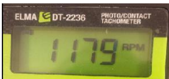
Figur 76 - Måling av RPM ved 20Hz (Tachometer)
