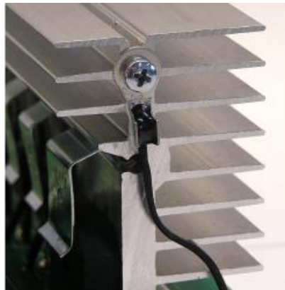
Figur 21 – NTC-motstand festet på kjøleribben til IGBTene (ST 2014, 23)
