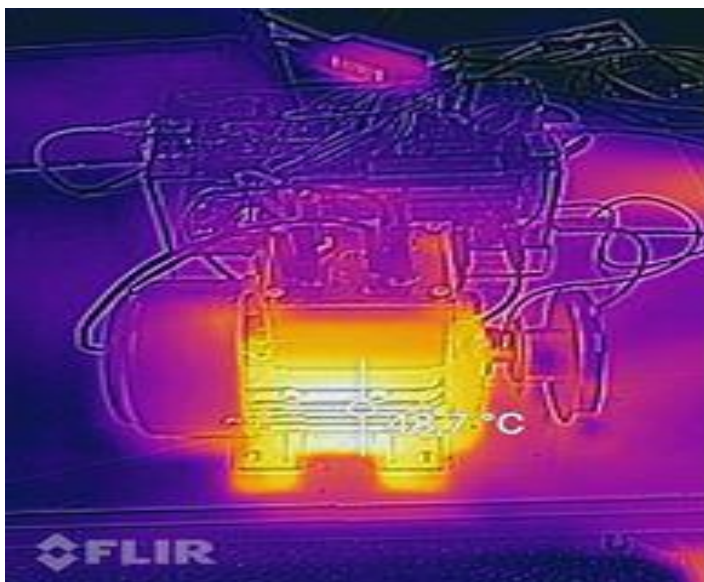
Figur 71 – Temperatur på motor (20Hz motordrift 5 min)
