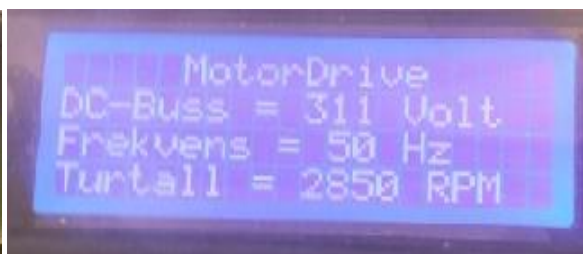
Figur 73 - Måling av RPM ved 50Hz (IR-sensor)
