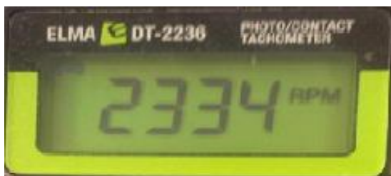
Figur 77 - Måling av RPM ved 40Hz (Tachometer)
