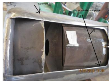
Figur 33 Bilde av oppskjært eksisterende varmeveksler
