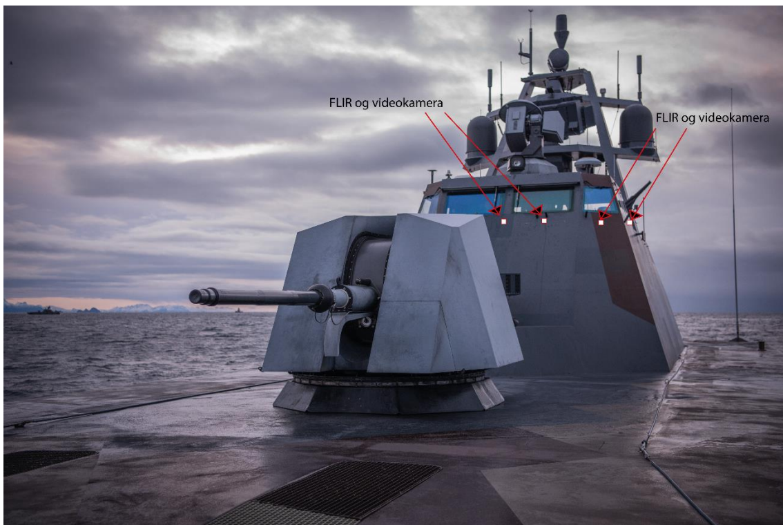
Figur 4.2: Oversikt over hvor kameraene vil bli montert på utsiden av broen (redigert bilde fra Forsvarets mediearkiv)
