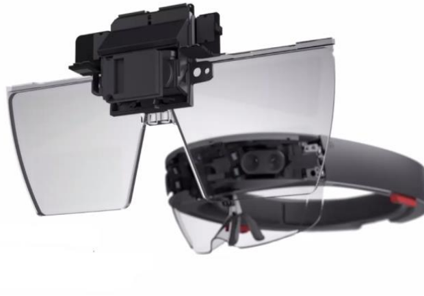
Figur 2.8: Hololens optiske kombinator med projektor (Microsoft, 2017)
