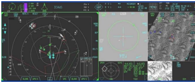
Bilde 4: Display i F-35. Skjermen kan deles opp etter flygers ønske, og fungerer som en touch-skjem. 11
