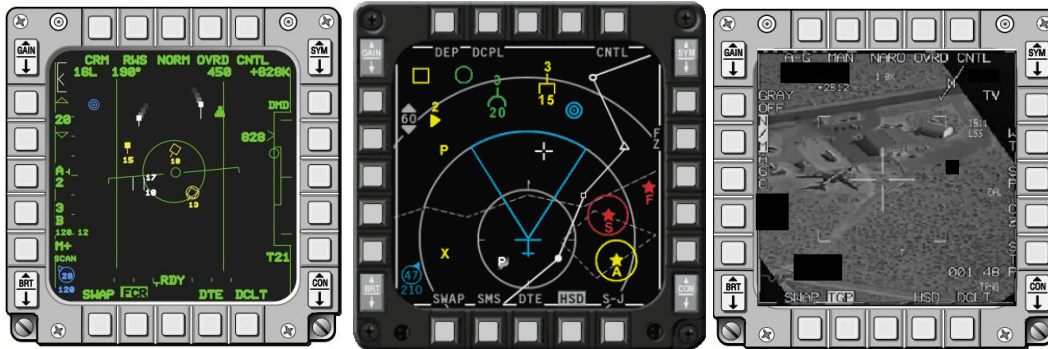
Bilde 3. Til venstre: modernisert radar. Midten: Oversiktsbilde. Til høyre: TGP mot bakkemål. 9
