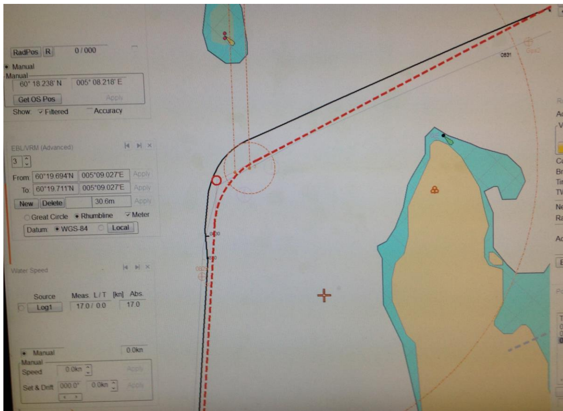
Figur 2: Bilde fra forsøk 2 med ukalibrert logg. Målt forskjell på GPS og Dead reckoning ble 30,6 meter med 2 knops ukalibrert logg. Kilde: Kongsberg ECDIS.
